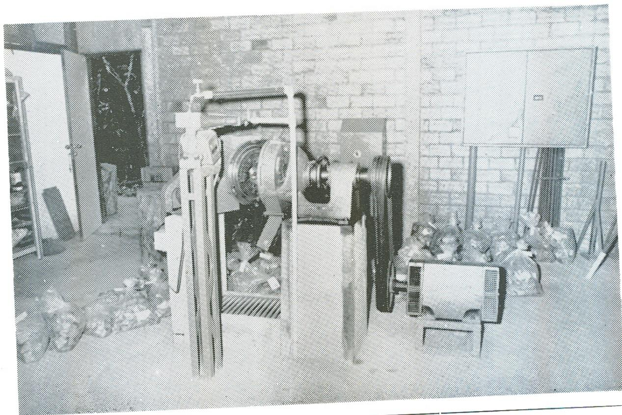
Fig. 10 — Sprout Waldron para obtenção de pasta mecânica. Foto: J. Romulo
